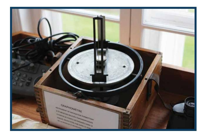
Le graphomètre est une petite table de lecture circulaire qui permet d'évaluer les déplacements du navire en regard de points de repères relevés sur les 360° autour du navire. Un viseur permet d'établir le degré d'observation du repère identifié. En relevant l'heure exacte de l'observation, celle-ci est reprise à temps fixe, donnant la position par rapport aux repères observés.
