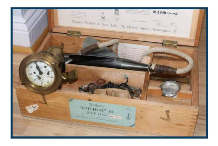
Instrument qui indique la vitesse de déplacement du navire, celle du courant... Son fuselage en forme d'hélice, attaché au navire donne lecture du courant, de la distance parcourue.
