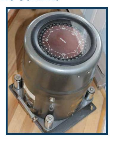
Appareil de navigation indiquant le nord géographique et non magnétique, ceci par l'application d'une loi physique, découlant de la vitesse de rotation de la terre, et de la distance à parcourir, différente selon notre éloignement des pôles.
